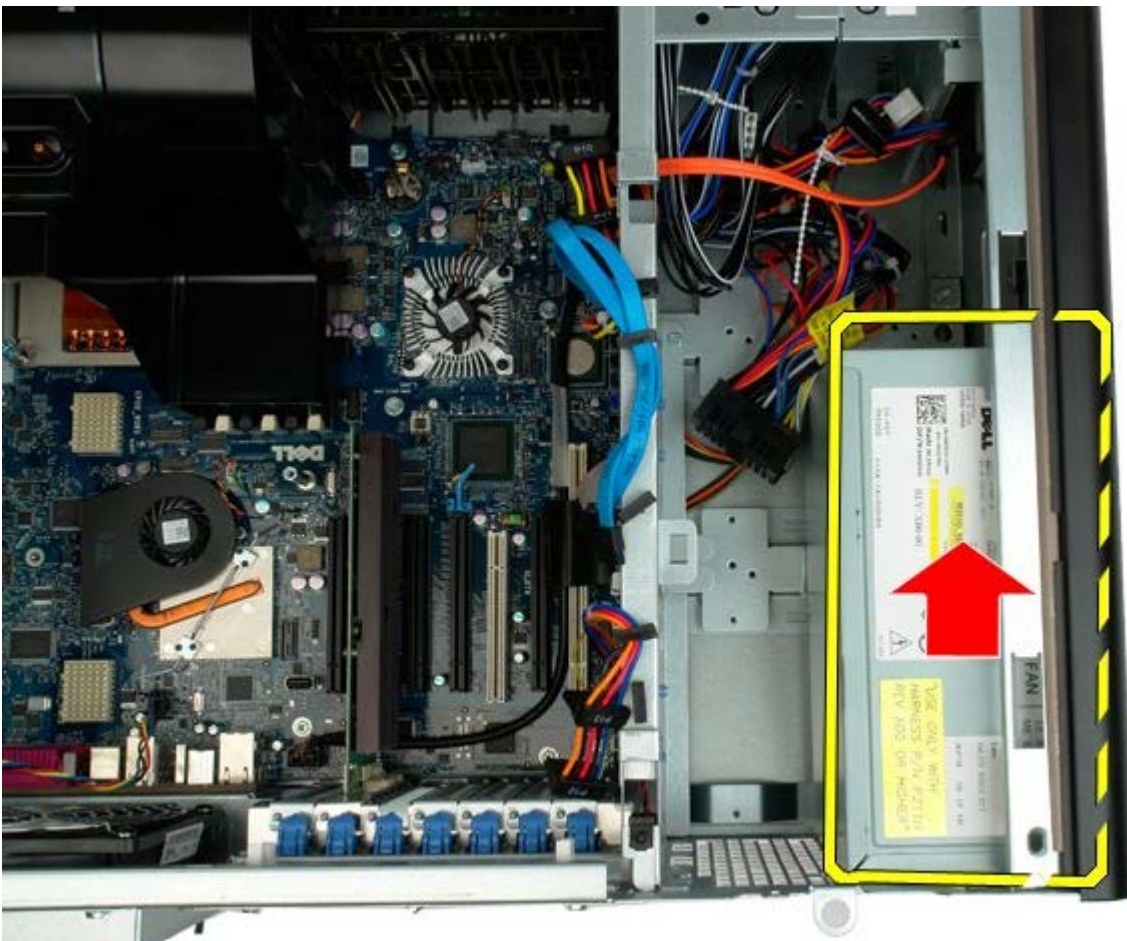
7. 以一定角度将电源设备从计算机中取出。
