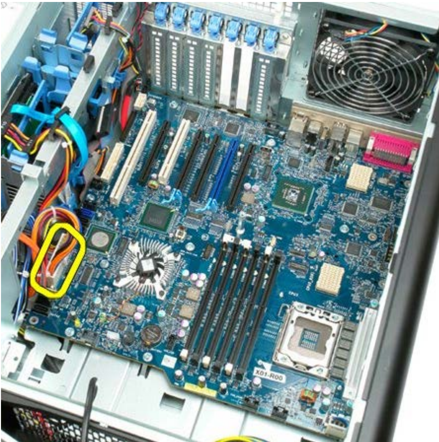
17. 断开光盘驱动器数据电缆的连接。
