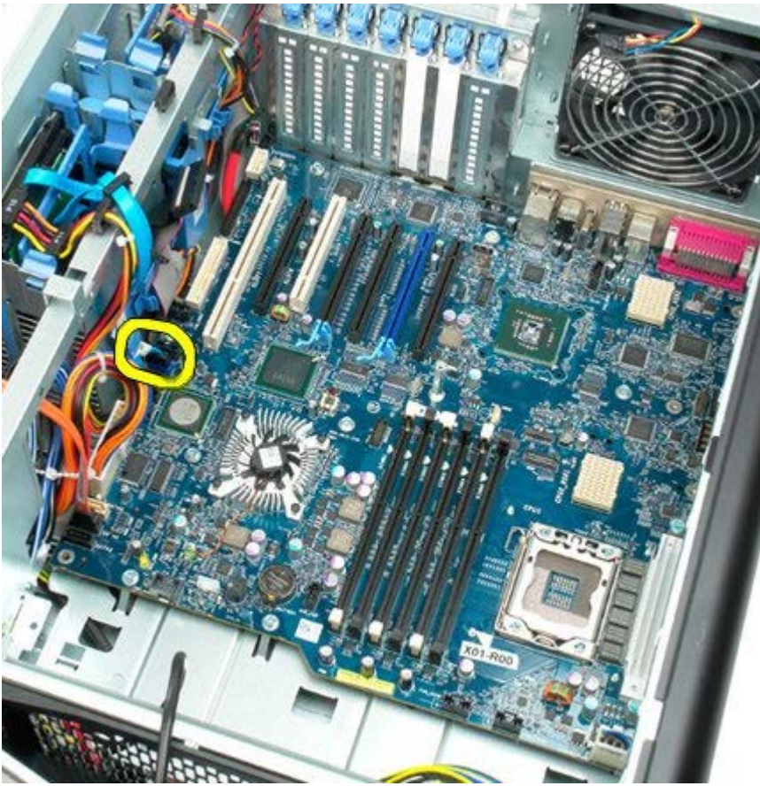
16. 断开电源设备电缆的连接。
