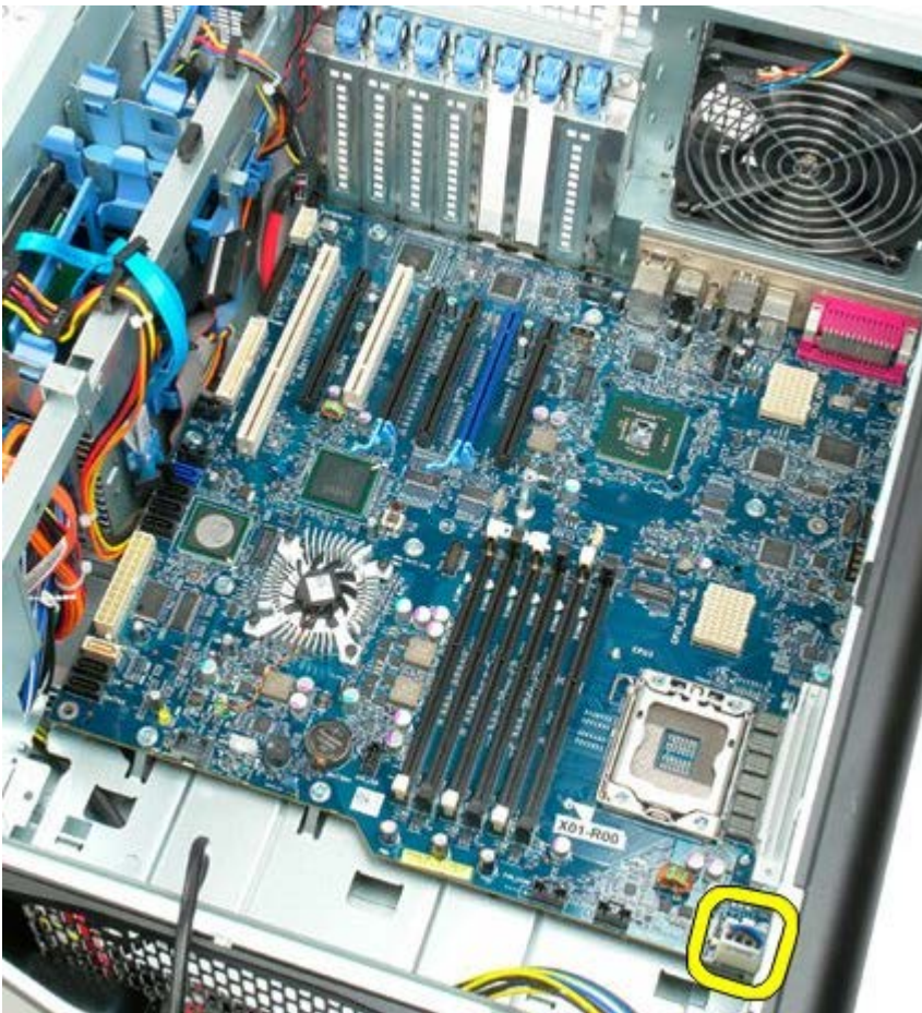
19. 拧下固定系统板的九颗螺钉。
